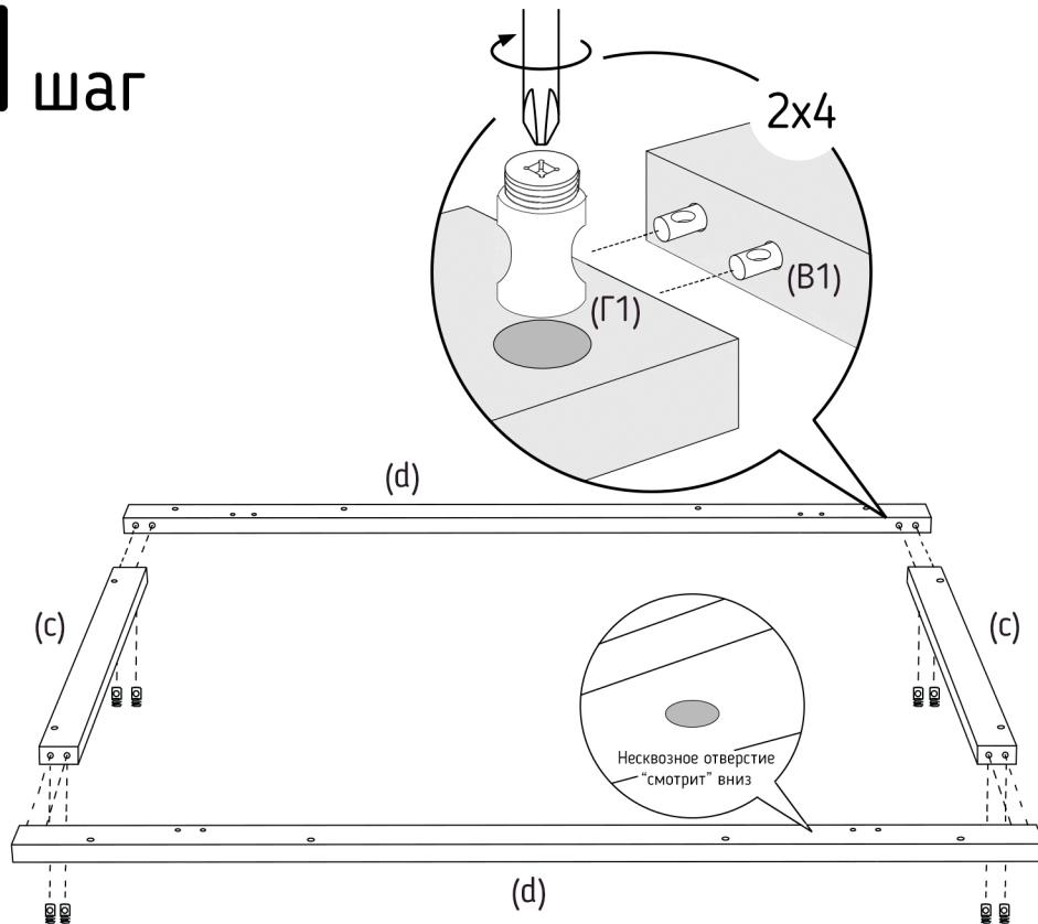
**Перед началом сборки убедитесь, что несквозные отверстия на продольных царгах (d) расположены снизу – они нужны для монтажа маятникового механизма (дополнительная опция).**
