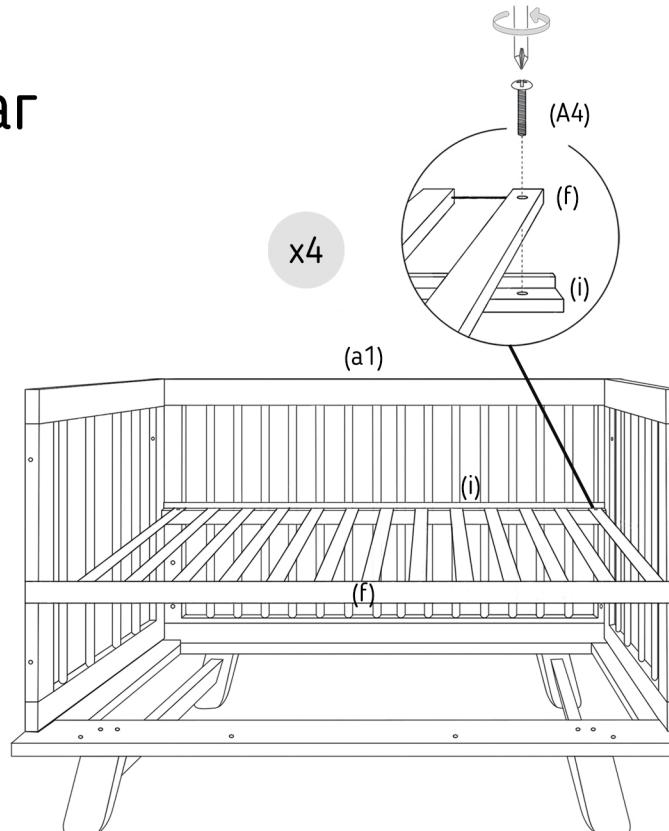
Положите реечное дно (f) поверх фиксаторов уровня высоты (i) и совместите отверстия во внешних углах решетки (f) и верхней поверхности фиксаторов (i). Соедините реечное дно с фиксаторами уровня высоты с помощью саморезов (Ж1). **Вы можете использовать кровать без одной установленной большой решетки в качестве приставной колыбели к родительской кровати. В таком случае, убедитесь, что уровень высоты спального ложа ребенка совпадает с высотой матраса кровати.**
