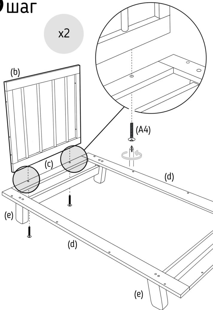
Совместите отверстия на верхней поверхности поперечной царги (c) с отверстиями на нижней поверхности малой решетки (b). С помощью винта (A4) зафиксируйте малую решетку (b) с обеих сторон.
