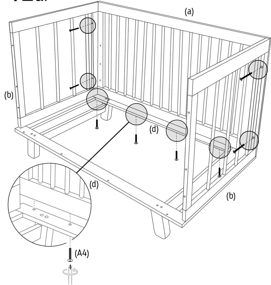
Установите на основание одну из больших решеток (a) и с помощью винтов (A4) соедините ее с продольной царгой (d) (4 винта) и с обеими малыми решетками (b) (по 2 винта с каждой стороны).
