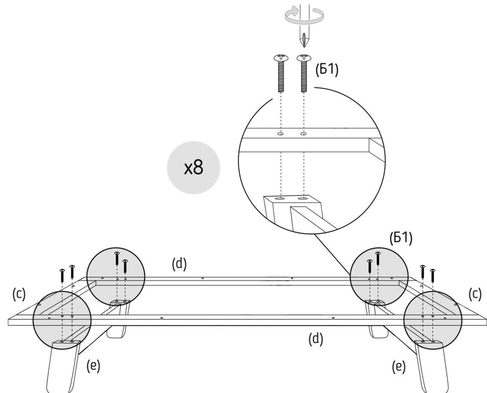
Совместите двойные отверстия на продольных царгах (d) и ножках кроватки (e) таким образом, чтобы угол наклона ножек был направлен “наружу”.
